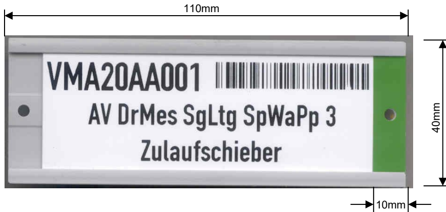
Abb. 7: Beschilderung funktionsbezogen zugeordnetes Aggregat mit Medium
